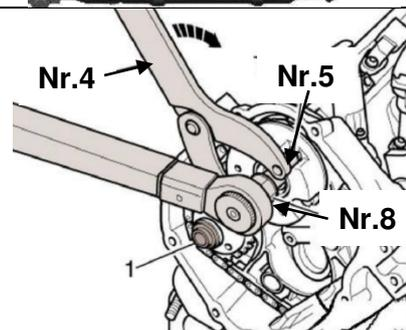
Mit dem Stiftschlüssel Nr.4 das Nockenwellenrad festhalten und Nockenwellenradschraube lösen.
