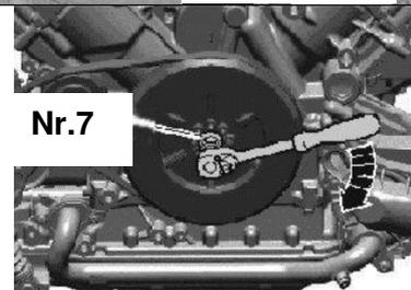
Spezialeinsatz Nr.8 an der Verstellerschraubung ansetzen und mit Gegenhaltewerkzeug Nr.4+5 den Versteller beim Lösen festhalten.
