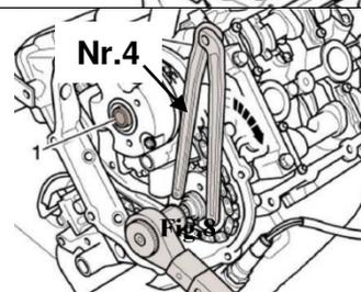
**ACHTUNG:** Verwenden Sie die Einstellwerkzeuge niemals als Gegenhalter beim Festziehen oder Lösen der Nockenwellenräder. Benutzen Sie dazu speziell dafür vorgesehene Gegenhaltewerkzeuge.
