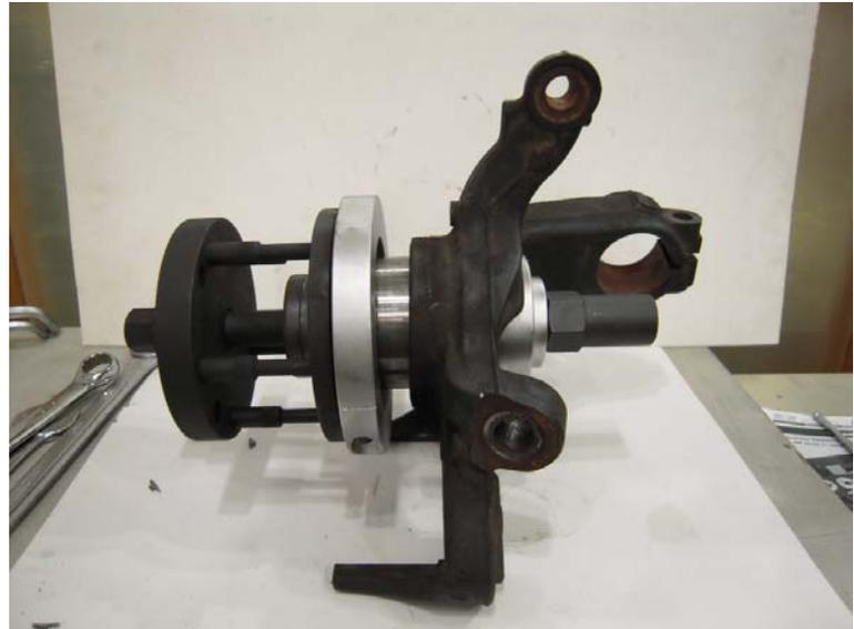
Mit der Druckspindel (1) und der Spindelmutter (7) das Radlager einziehen.
