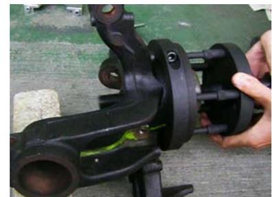
Spindel (1) mit aufgesetzter Druckplatte (2) von vorne aufsetzen, so dass die montierten Druckstifte (3) durch die Radbolzen-Bohrungen an der Demontageschalen (4) anliegen.
