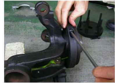
Druckstifte (3) vorsichtig mit einem Hammer in die Druckplatte einschlagen, dabei müssen Druckstifte (3) auf dem gleichen Lochkreis der Radnabe liegen.
