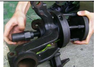
Durch Drehen der Druckspindel (1) und gegenhalten der Spindelmutter (7) die alte Naben-Lagereinheit ausziehen.
