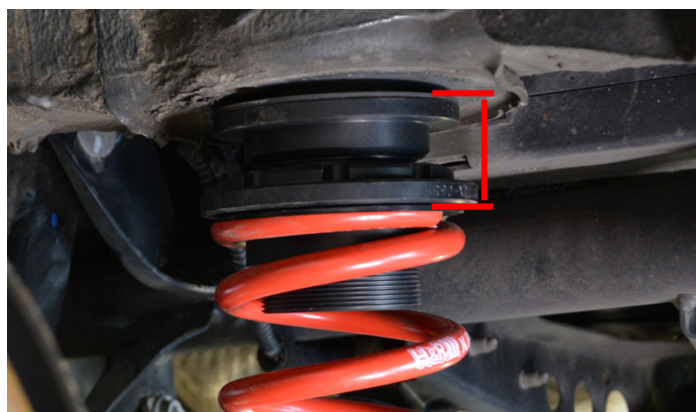
Bild 5: Einstellmaß HA Fig. 5: RA spring plate adjustment dimension
