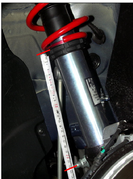
Bild 4: Einstellmaß VA Fig. 4: FA spring plate adjustment dimension
