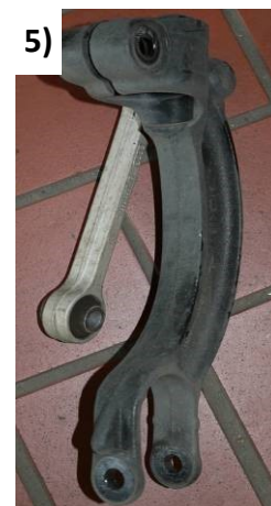
5) Dämpferklemmverbindung mit geeignetem Werkzeug vorsichtig spreizen. Dämpfergabel mit Pendelstütze ausbauen.
