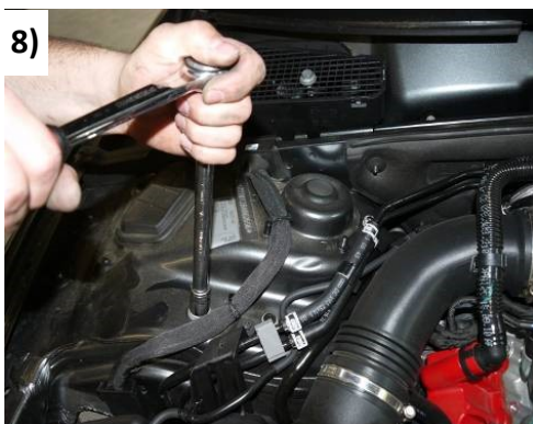
8) Verschraubung im Motorraum lösen.
