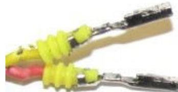
4. Öffnen Sie vorab die Steckersicherung. Die montierte und abgedichtete Leitung wird vollständig in das Gehäuse eingeschoben bis sie einrastet. Die Pinposition / Kabelfarbe ist hierbei nicht relevant. Anschließend muss das Steckergehäuse wieder verriegelt werden.
