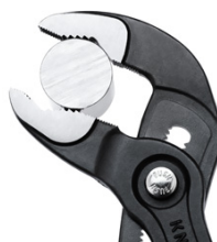
Gegen die Drehrichtung versetzte Zähne bewirken einen Selbstklemmeffekt und verhindern das Abrutschen am Werkstück.
