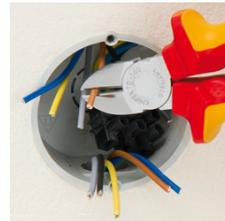
Schlanke Kopfform und exakter Schnitt an den Schneidenspitzen: vorteilhaft beim Einsatz in schwer zugänglichen Arbeitsbereichen
