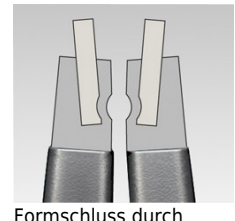
Formschluss durch Verpressung
