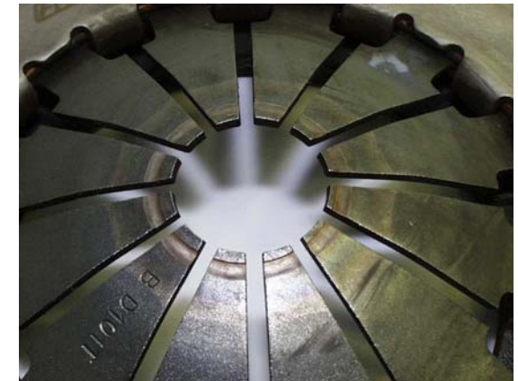
Precarico basso o manicotto danneggiato
