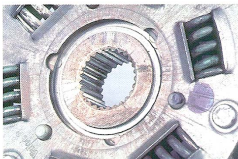
L'ammortizzatore del disco è stato danneggiato
