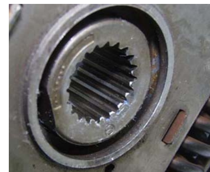
Mozzo del disco danneggiato
