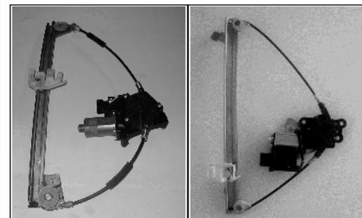
Alzacristallo originale - oem window regulator - lève-vitre original - Fensterheber von oem - elevallas original - levántador de vidro original orijinal cam acacagi - Γρύλος γνήσιος
