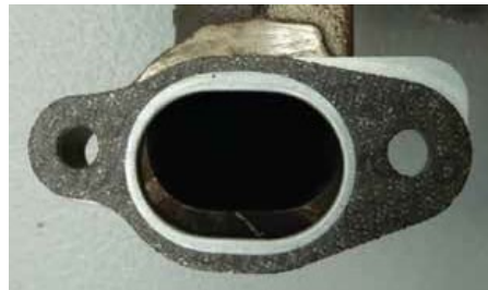
Nicht korrekte Montage
