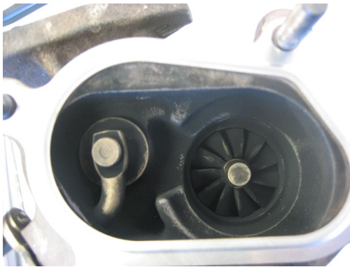
Junta montada incorrectamente.
