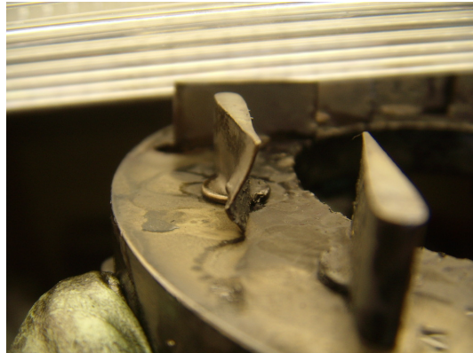
Aubes de tuyère endommagées.
