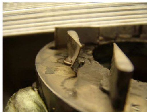
Beschädigte Düsen der Laufschaufeln.
