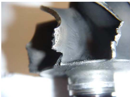
Poškozená výfuková turbína
