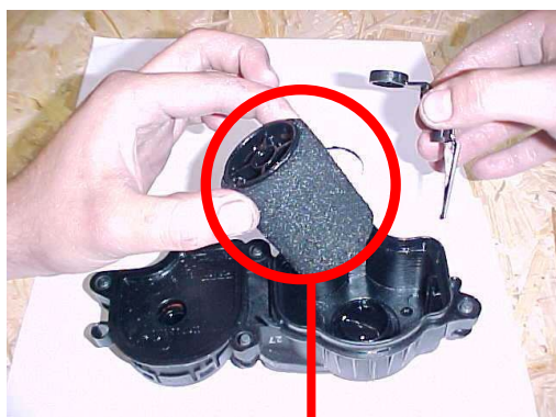
FILTRO CEGADO. INUTILIZADO.
