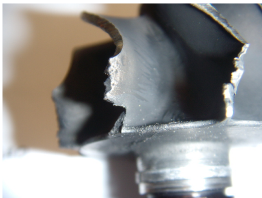
Beschadigde turbine uitlaat.
