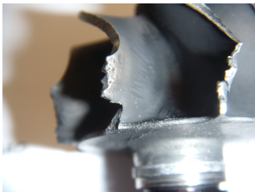
Turbina do escape danificada.
