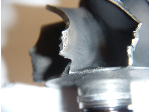
Turbine d'échappement endommagée.
