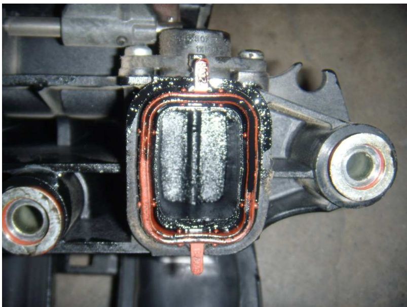
Plastové sací potrubí s další hvězdicovitou klapkou.
