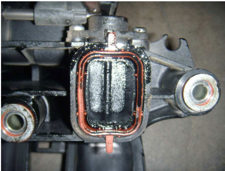
Luftansaugrohr aus Plastik mit zusätzlicher Turbulenzverschlussklappe.
