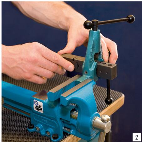
Schieben Sie dann die Spannbacke (3) so in das Grundgerät (2), dass die Seite mit der Aufschrift „180°“ (bei älterer Spannbacke lautet die Aufschrift „F“) nach oben zeigt.
