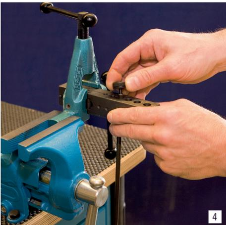
Stecken Sie das gleitfähig gemachte und dem Rohrdurchmesser entsprechende Druckstück auf das Rohr. Setzen Sie das Vorgabestück (5) mit der Öffnung nach unten darauf. Dann schieben Sie die Spannbacke (3) soweit in das Gerät, bis das Rohrende mit dem Druck- und Vorgabestück (5) unter der Druckspindel liegt.
