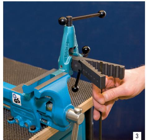
Öffnen Sie die Spannbacke (3). Das zu bördelnde Rohr oben einige Millimeter überstehen lassen. Das Vorgabestück (5) dient nun als Einstellehre. Das Rohr mit Hilfe des Vorgabestück (5) mit der Aussparung nach unten bis zur Spannbacke (3) herunterdrücken. Spannbacke (3) schließen.
