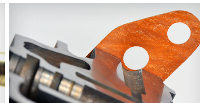
Junta deformada y mal colocada
