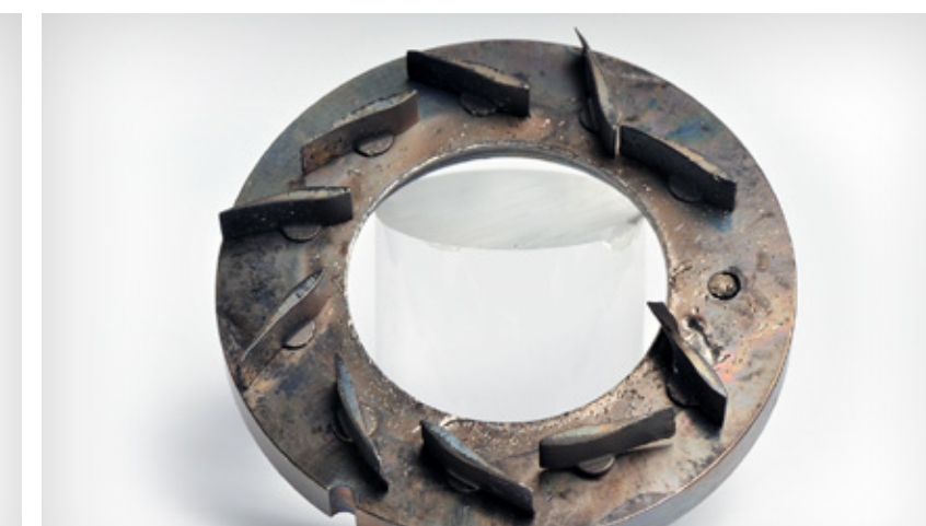
Schaden an einem Turbinenrad
