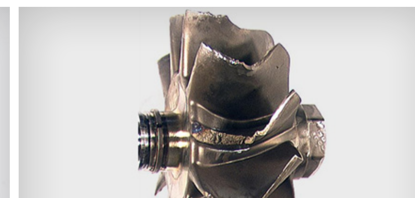
Turbinenrad mit Materialermüdung durch wiederholtes Überschreiten der Höchstdrehzahl
