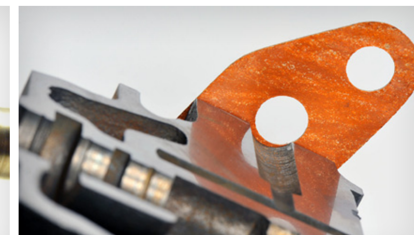
Falsche Form und Einbaulage der Dichtung
