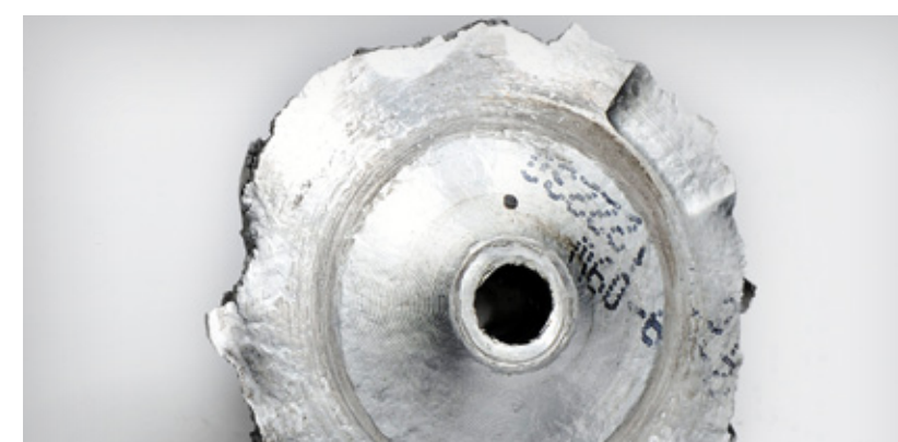
Die „Orangenhaut“ auf der Rückseite dieses Verdichterrads ist ein eindeutiges Anzeichen für das Überschreiten der Höchstdrehzahl
