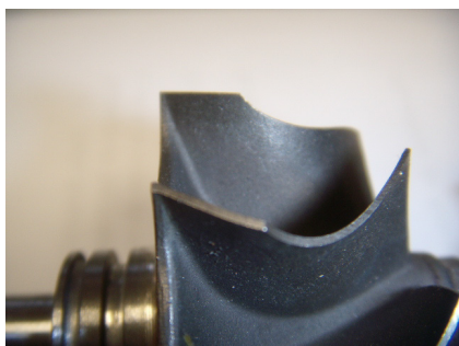
Turbina dello scarico senza danni
