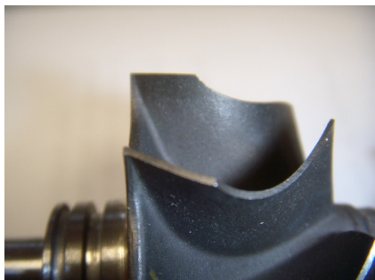
Nepoškodovana izpušna turbina
