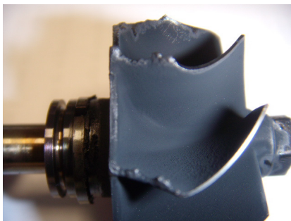
Poškodovana izpušna turbina
