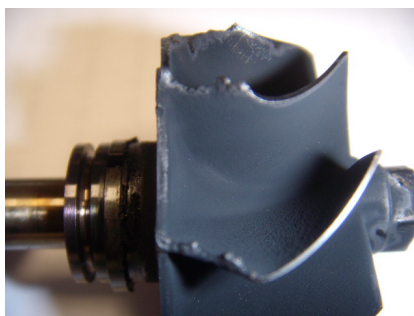
Turbina scarico danneggiata
