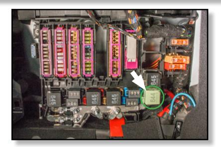
RELAY IS LOCATED AT THE FRONT RIGHT-HAND SIDE OF THE LUGGAGE COMPARTMENT
