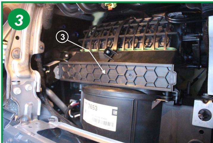
Ouvrir le boîtier filtrant (3) en agissant sur le fermoir situé à gauche.
