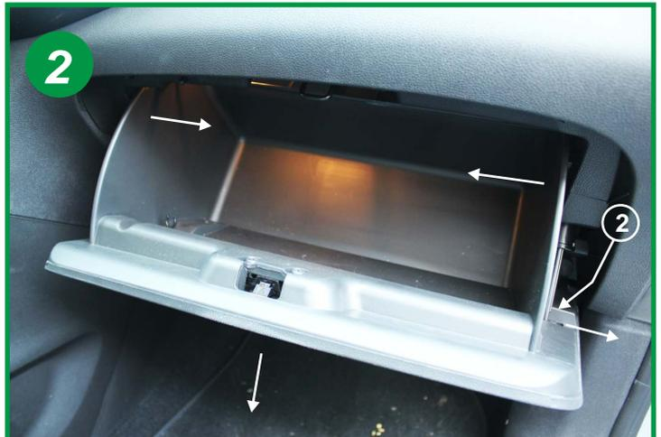
Débrancher l'amortisseur de descente de tiroir (2) dans le sens de la flèche.
