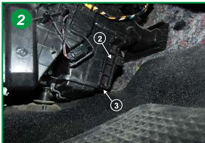
Localiser le boîtier filtrant (2). Pour l'ouvrir exercer une pression dans la partie inférieure du couvercle (3).
