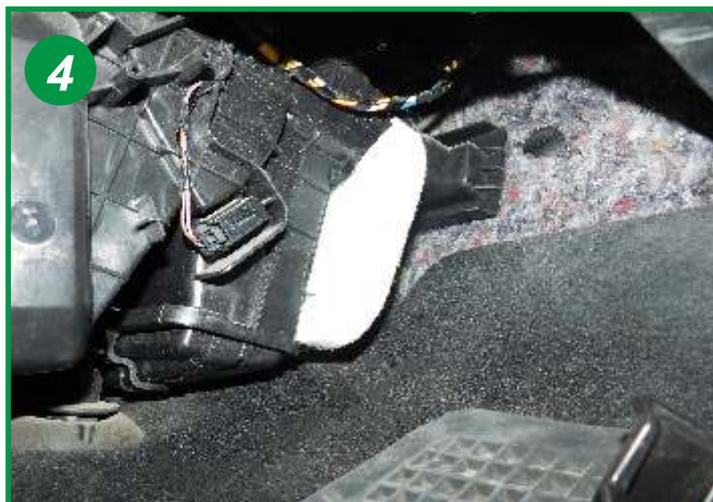
Extraire le filtre usagé en le déformant, l'ouverture du climatiseur étant plus petite. Procéder à son remplacement. Le remontage s'effectue dans l'ordre inverse du démontage.
