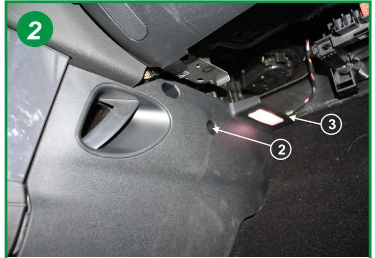
Dévisser la vis torx (T20)(2) et dégrafer le carter. Une fois dégrafé, débrancher la cosse électrique du plafonnier (3). Voir détail en photo 3
