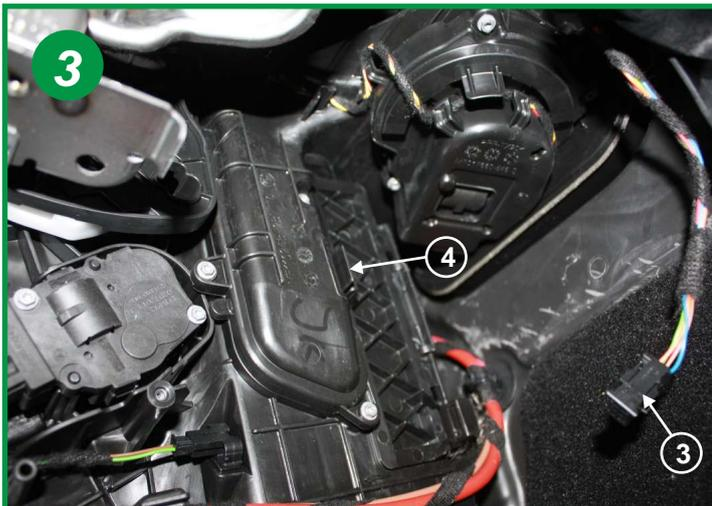
Ouvrir le boîtier filtrant en actionnant la poignée (4), le couvercle du boîtier est articulé sur la droite. Retirer le couvercle dans sa totalité.
