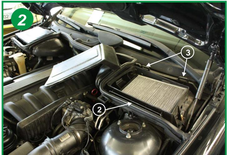
Basculer le fermoir (2) et retirer le capot de filtre en le dissociant des 2 anses de charnière (3)
