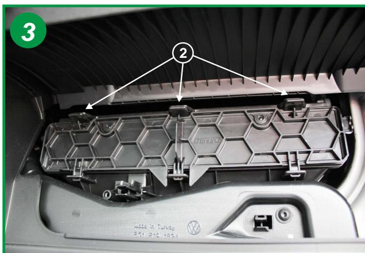
Soulever les 3 pattes de fermeture du boîtier filtrant (2) et ouvrir celui-ci.
