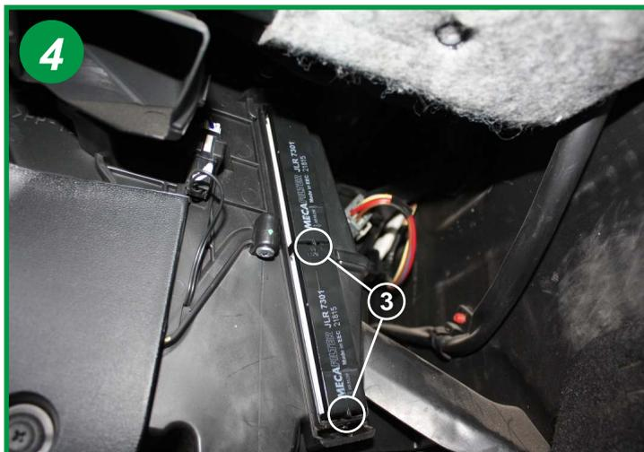
Replacer des filtres neufs en respectant le guidage (3). Une fois le résultat ci-dessus obtenu, replacer le couvercle du boîtier en pressant jusqu'à l'obtention du clic.
