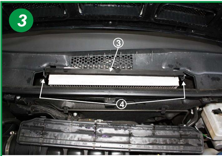
Soulever le volet qui ferme le boîtier filtrant (3) en agissant sur les 2 clips de fermeture placés aux deux extrémités (4).
