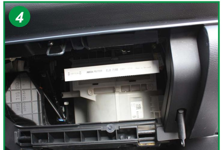
Sortir le filtre usagé et le remplacer. Le remontage s'effectue dans l'ordre inverse du démontage.
