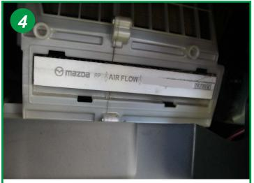
Extraire I 'élément filtrant usagé et le remplacer. Le remontage s 'effectue dans I 'ordre inverse du démontage.
