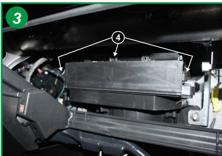
Ouvrir le boîtier filtrant à l'aide des fermoirs (4), le couvercle est articulé par une charnière dans sa partie inférieure.
