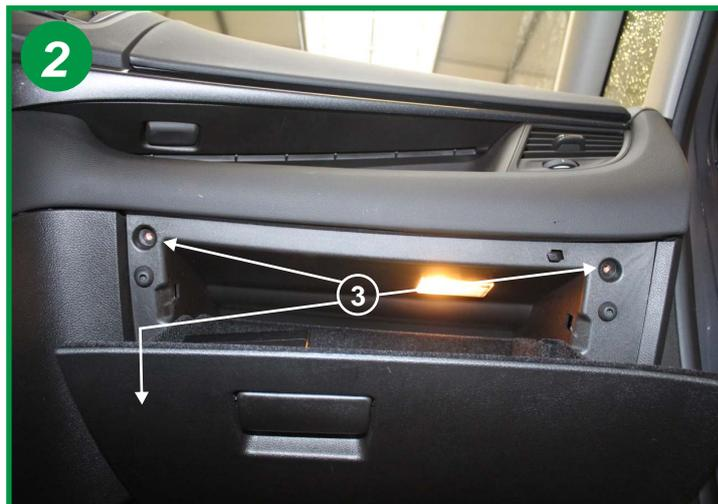
Ouvrir la boîte à gants et dévisser les 3 autres vis de 5,5 mm (3), déboîter l'ensemble de la boîte à gants puis débrancher l'éclairage de celle-ci. Extraire la boîte à gants.
