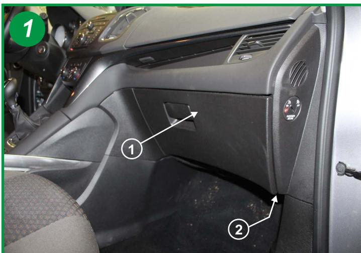
Le filtre habitacle est situé à l'intérieur du véhicule, coté passager derrière la boîte à gants (1). Dévisser la vis tête hexagonale de 5,5 mm à droite et en dessous du tiroir de boîte(2).
