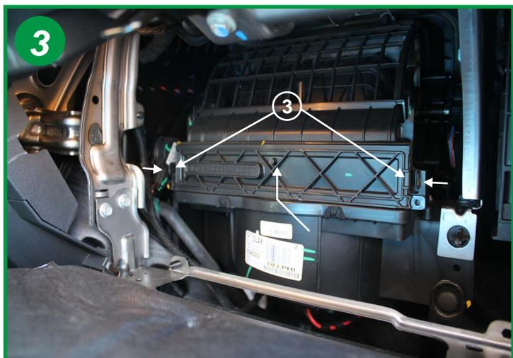
Appuyer sur les languettes (3) placées de chaque coté du boîtier filtrant pour ouvrir celui-ci.
