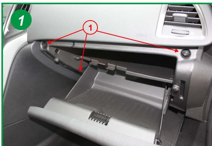
Le filtre d'habitacle est situé à l'intérieur du véhicule coté passager derrière la boîte à gants.
