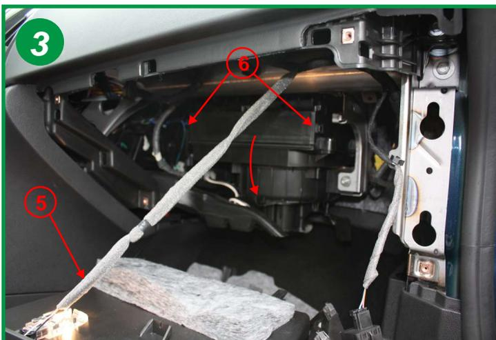
Sortir le bloc boîte à gants dans sa totalité, il n'est pas nécessaire de débrancher l'éclairage (5).
