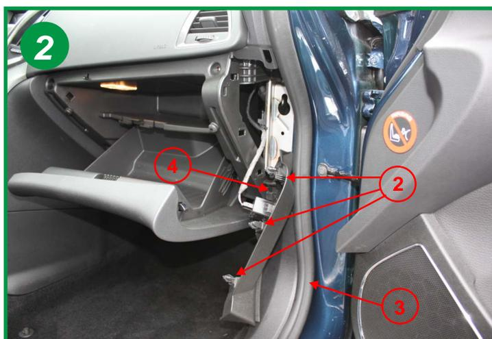
Démonter le flanc droit de la planche de bord en exerçant une pression assez forte (clips métalliques) (2) ne pas débrancher la commande de l'air-bag.
