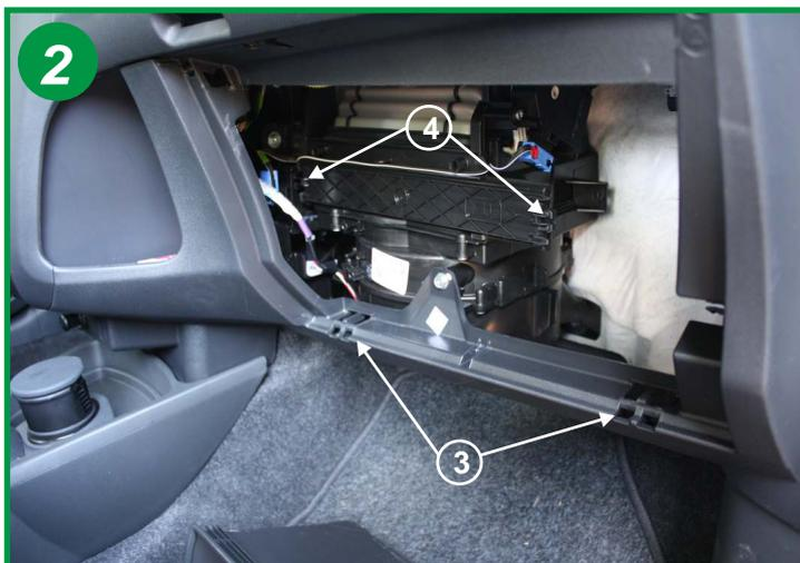
Retirer le tiroir de boîte à gants dans sa totalité en le soulevant pour le dissocier de la charnière (3). Ouvrir le boîtier filtrant à l'aide des 2 fermoirs (4) à chaque extrémité du couvercle.
