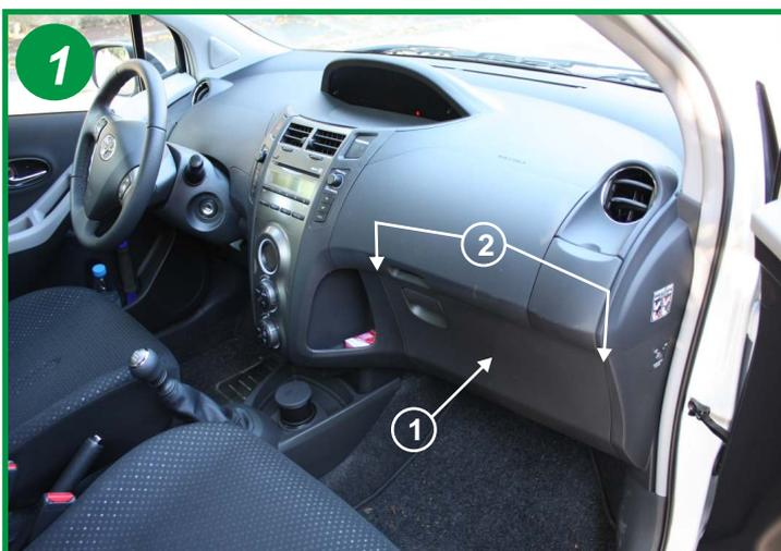
Le filtre d'habitacle est situé à l'intérieur du véhicule, coté passager derrière la boîte à gants (1). Ouvrir la boîte à gants et dégager les arrêtoirs à droite et à gauche du tiroir (2).
