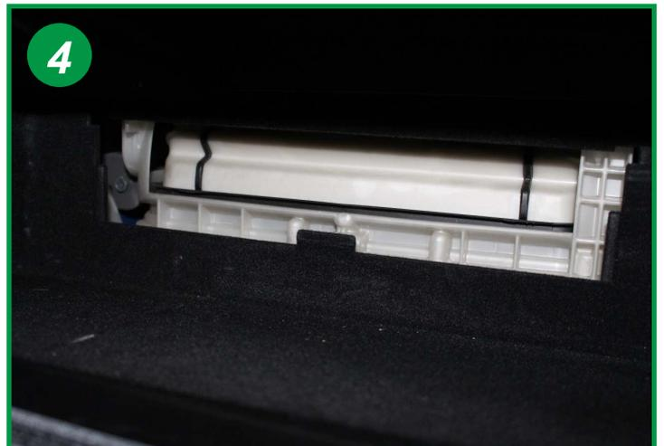
Le boîtier filtrant est fermé électriquement, ne pas forcer pour l'ouvrir. (voir photos 5 pour activer son ouverture).
