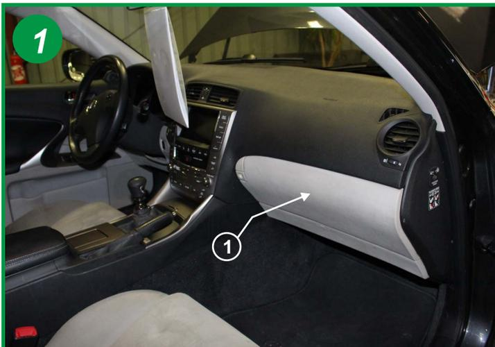
Le filtre d'habitacle est situé à l'intérieur du véhicule, coté passager dans le fond de la boîte à gants (1). Ouvrir la boîte à gants.
