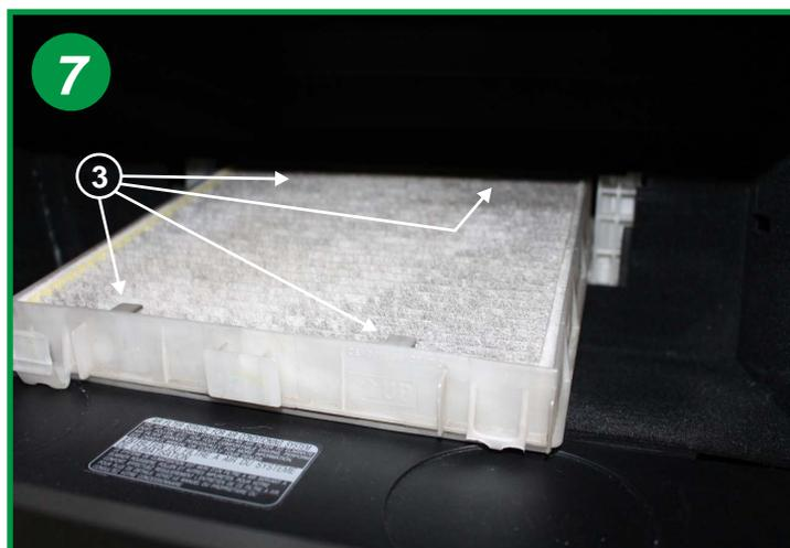
Sortir l'élément filtrant usagé et replacez en un neuf en l'imbriquant sous les ergots (3) afin de le plaquer au fond du cadre.
