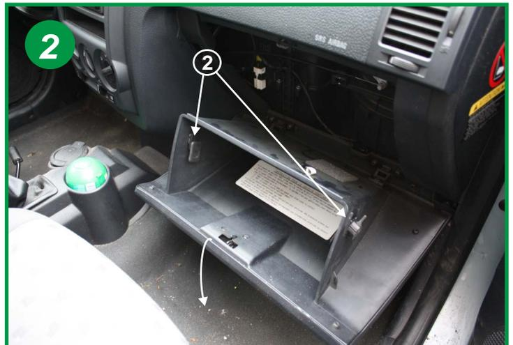
Ouvrir la boîte à gants, retirer les 2 arrêteurs souples (2) et basculer la boîte à gants vers le bas.
