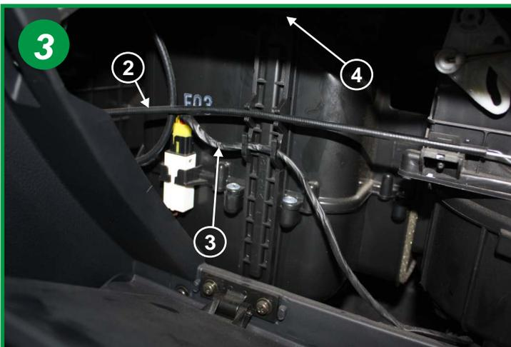
Ecarter le câble (2) et la connexion électrique (3) et retirer le couvercle du boîtier filtrant en tirant sur la patte située dans sa partie supérieure (4).
