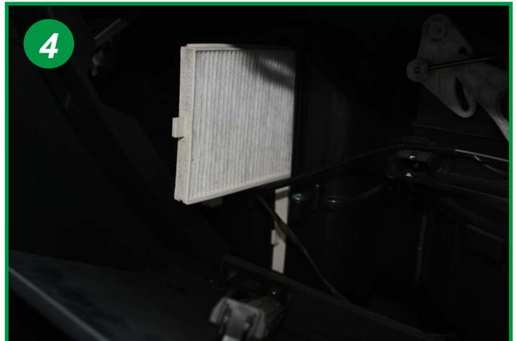
Extraire les éléments filtrants usagés et le remplacer. Le remontage s'effectue dans l'ordre inverse du démontage.
