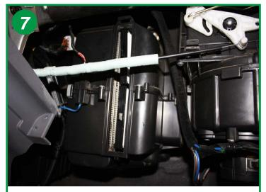
Une fois les éléments remplacés refermer le couvercle du boîtier filtrant en glissant sa partie supérieure dans l'oeillet (8). A sa fermeture, un clic doit se faire entendre.
