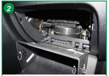
Actionner les arrêtoirs dans le sens des flèches et basculer le tiroir de la boîte à gants vers le bas.
