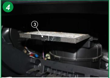
Extraire I 'élément filtrant usagé en tirant sur la poignée (3) et procéder à son remplacement. Le remontage s 'effectue dans I 'ordre inverse du démontage.
