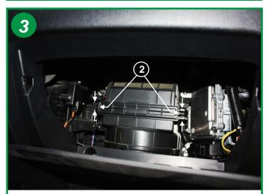
Appuyer sur les petites pattes aux 2 extrémités (2) du couvercle du boîtier filtrant dans le sens des flèches et retirer ce couvercle.
