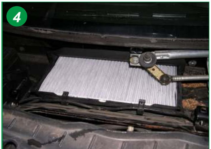
Installer le nouvel élément en veillant à positionner le joint mousse vers le bas. Faire glisser l'élément jusqu'au fond de son logement en comprimant légèrement le joint et le faire basculer pour l'encliqueter correctement.
