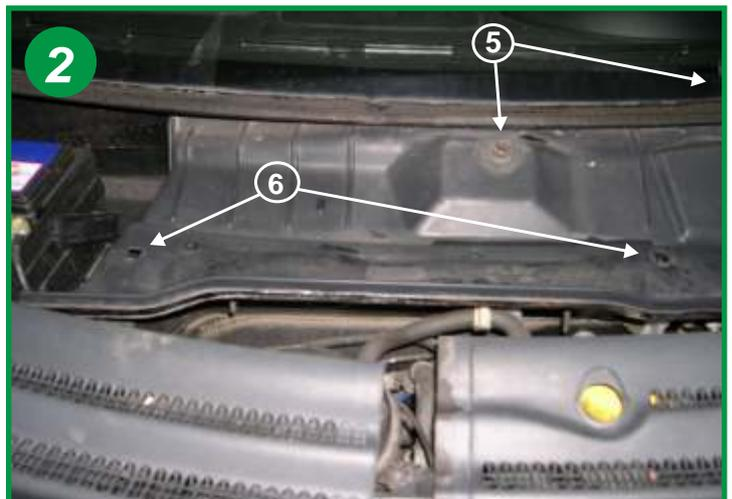
Retirer les 2 écrous hexagonaux plastiques et rondelles d'appui des axes de bras d'essuie-glaces (voir flèche 5)
