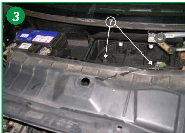
Basculer les 2 clips plastiques sur le boîtier du filtre (flèche 7).
