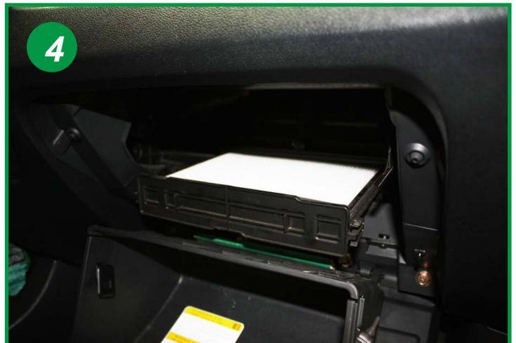
Sortir le tiroir et extraire le filtre usagé du cadre, le remplacer en imbriquant les premiers plis des 2 extrémités dans le nervures prévues à cet effet. Le remontage s'effectue dans l'ordre inverse du démontage.
