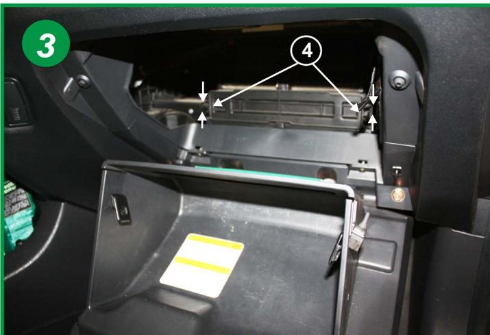
Basculer le tiroir de boîte à gants jusqu'au plancher de l'habitacle. Appuyer sur les 2 fermoirs (4) pour libérer le tiroir du boîtier filtrant
