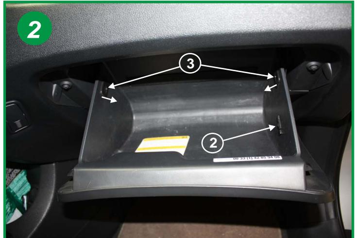
Ouvrir la boîte à gants, ôter l'arrêt (2) en tirant dessus et en le faisant ressortir par son trou, dégager ensuite les 2 butées (3) en soulevant les 2 supports plastiques.
