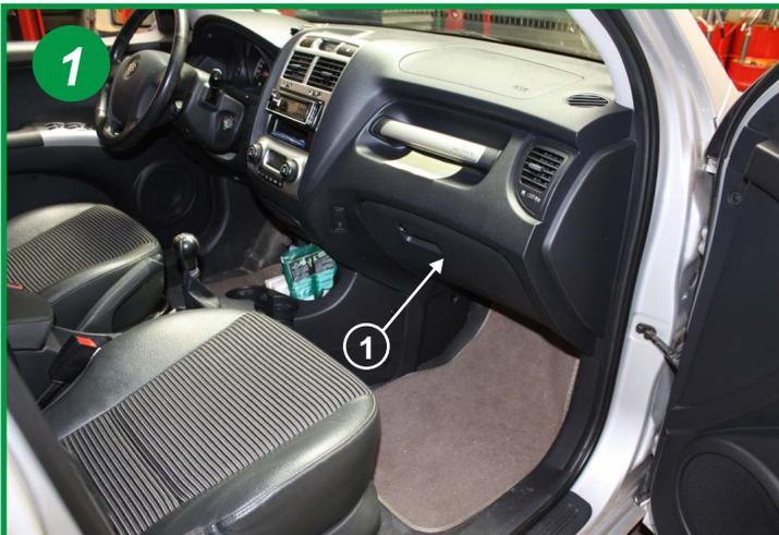
Le filtre d'habitacle est situé dans le véhicule, côté passager, derrière la boîte à gants (1).
