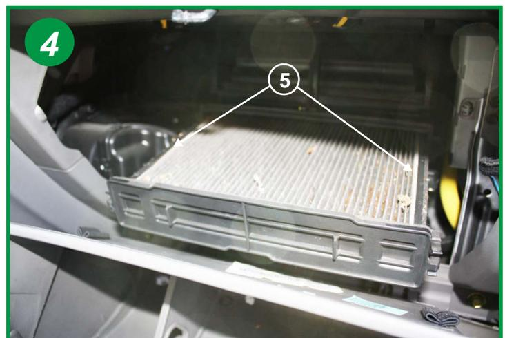
Sortir le tiroir et son élément filtrant, le retirer de son cadre plastique et le remplacer. Attention imbriquer les 2 premiers plis dans les nervures appropriées (5). Le remontage s'effectue dans l'ordre inverse du démontage.
