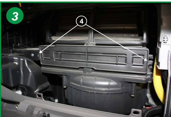
Ouvrir le boîtier filtrant en appuyant aux deux extrémités (4) sur les fermoirs.
