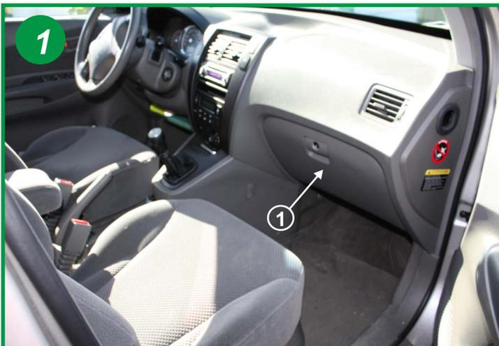
Le filtre d'habitacle est situé à l'intérieur du véhicule, coté passager derrière la boîte à gants (1).
