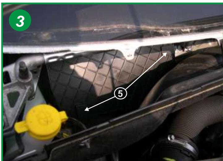
Localiser le boîtier du filtre d'habitacle. Déclipser le couvercle du boîtier (voir flèche 5)
