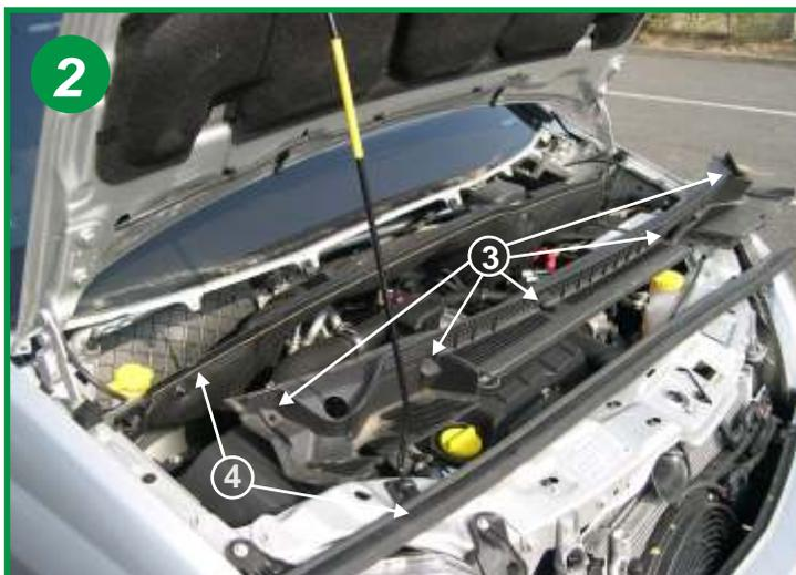
Retirer les 5 vis de fixation de la grille d'aération (flèche 3) et le joint d'étanchéité du capot moteur (flèche 4).
