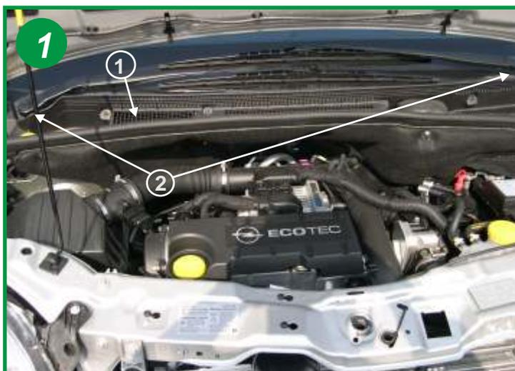
L'élément filtrant est situé sous la baie de pare brise coté passager (voir flèche 1). Ouvrir le capot moteur et retirer les balais d'essuie-glaces après avoir ôté les caches vis et les 2 écrous hexagonaux. (voir flèche 2).
