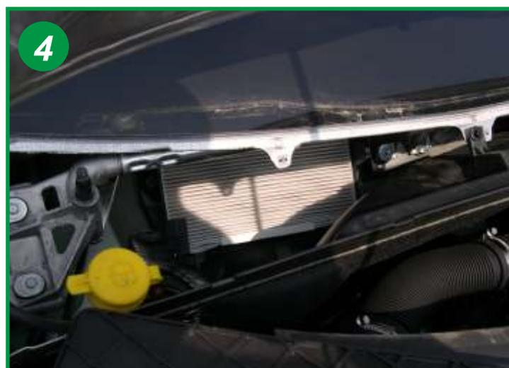
Extraire l'élément filtrant usagé en le déformant afin de le sortir de son emplacement. Le remplacer. Le remontage s'effectue dans l'ordre inverse du démontage.
