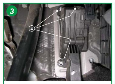
Dévisser les 3 écrous de 13 qui maintiennent la platine de la pédale d'accélérateur (4), retirer celle-ci sans la débrancher et la mettre sur le coté.
