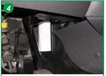
Ouvrir le boîtier filtrant en dévissant la vis de 5,5 mm sur le couvercle, extraire le filtre usagé et le remplacer. Le remontage s'effectue dans l'ordre inverse du démontage.
