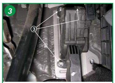
Dévisser les 3 boulons de 10 de maintien de la pédale d'accélérateur, et la mettre sur le coté (3).
