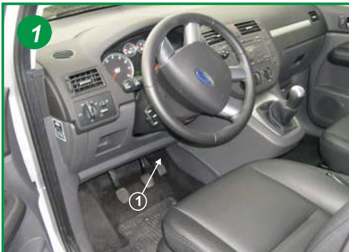
L'élément filtrant est situé dans l'habitacle du véhicule coté conducteur derrière la pédale d'accélérateur.
