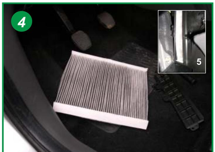
Retirer l'élément filtrant usagé (5) en le tirant de son boîtier et le remplacer. Le remontage s'effectue dans l'ordre inverse du démontage.
