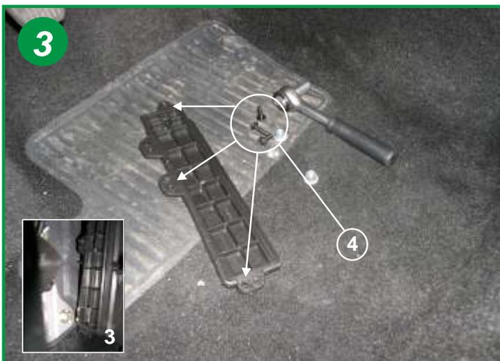
Localiser le boîtier du filtre d'habitacle en position verticale sur le coté de la console centrale (3), puis dévisser les 3 vis de fixation du couvercle de ce boîtier (voir flèche 4).
