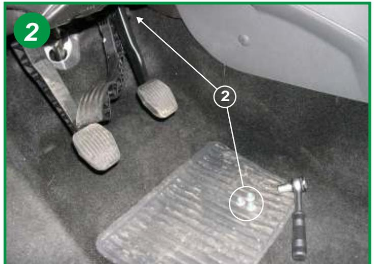
Dévisser les 3 écrous hexagonaux de la platine de maintien de la pédale d'accélérateur et la positionner sur le coté (voir flèche 2).
