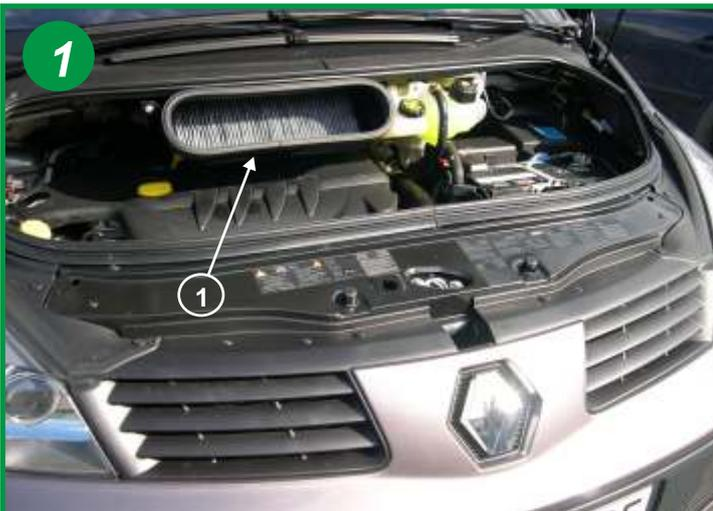
L'élément filtrant est situé sous le capot moteur au centre.
