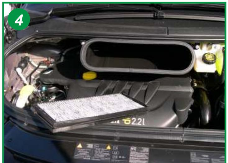
Remplacer l'élément filtrant.
