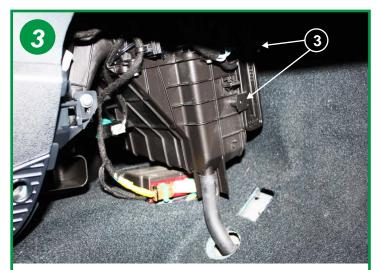
Dévisser les 2 vis de 5,5 mm qui maintiennent le couvercle de boîtier filtrant en position (3) et retirer le couvercle. (Attention sur certains modèles de voiture, ces 2 vis sont absentes)
