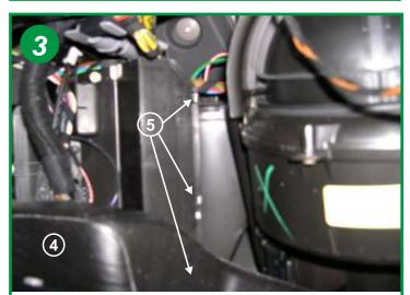
Ouvrir le boitier filtrant après avoir retiré les 3 clips de fermeture (voir flèche 5).
