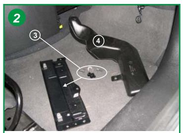
Retirer ensuite la plaque de renfort fixée par 4 vis (flèche 3). Dèboiter le conduit de ventilation et le retirer (4).
