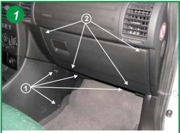
L'élément filtrant est situé derrière la boîte à gants. Retirer le cache sous la boîte à gants en retirant ces vis et ces 2 clips situés au dessous (flèche 1).
