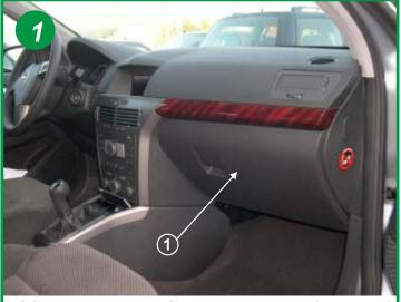
L'élément filtrant est situé dans l'habitacle du véhicule coté passager derriére la boîte à gants. (Flèche 1).
