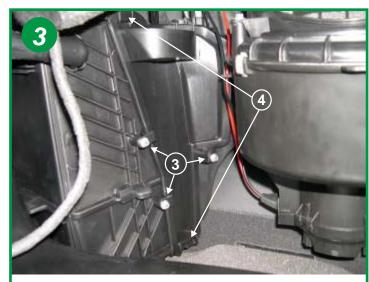
Dévisser ensuite les 3 vis fixant le couvercle du boitier du filtre d'habitacle (flèche 3), retirer ce couvercle en faisant pression sur les pattes d'encliquetage situées aux deux extrémités de celui-ci (flèche 4).
