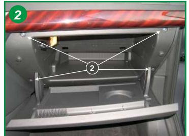
Ouvrir la boîte à gants, dévisser les quatre vis cruciformes fixant celle-ci (voir flèche 2) puis la retirer. Veiller à débrancher les 2 cosses électriques d'alimentation de l'éclairage de la boîte à gants.
