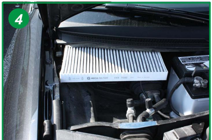
Extraire l'élément filtrant usagé et le remplacer.
