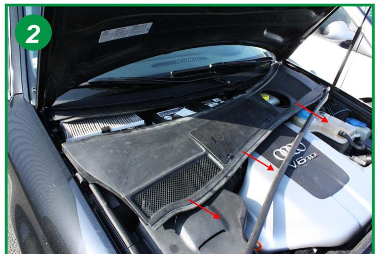
Retirer le carter de protection dans sa totalité en tirant fermement dans le sens des flèches.
