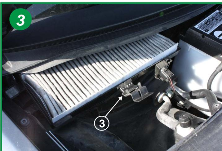
Dégager l'élément filtrant après avoir basculé le loquet de fermeture du boîtier (3).
