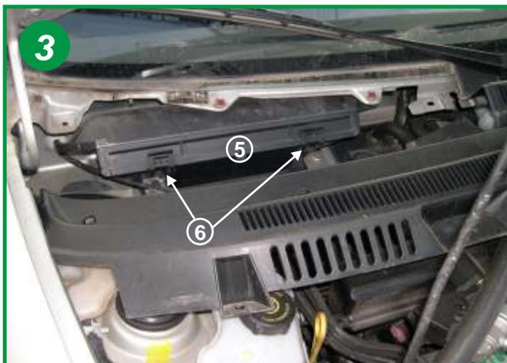
Localiser le boîtier du filtre (5). Actionner les 2 attaches plastiques (flèches 6). Soulever le volet pour en extraire l'élément filtrant usagé.
