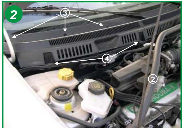
Retirer sur la moitié le joint d'étanchéité du compartiment moteur (2), puis les 3 caches et leur vis (flèche 3) et les 2 vis à tête cruciforme (flèche 4) pour retirer la moitié de la grille d'aération.
