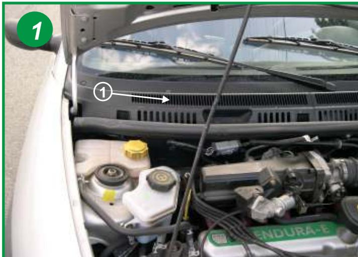
L'élément filtrant est situé sous la baie du pare brise sous le capot moteur coté passager (voir flèche 1). Ouvrir le capot moteur.
