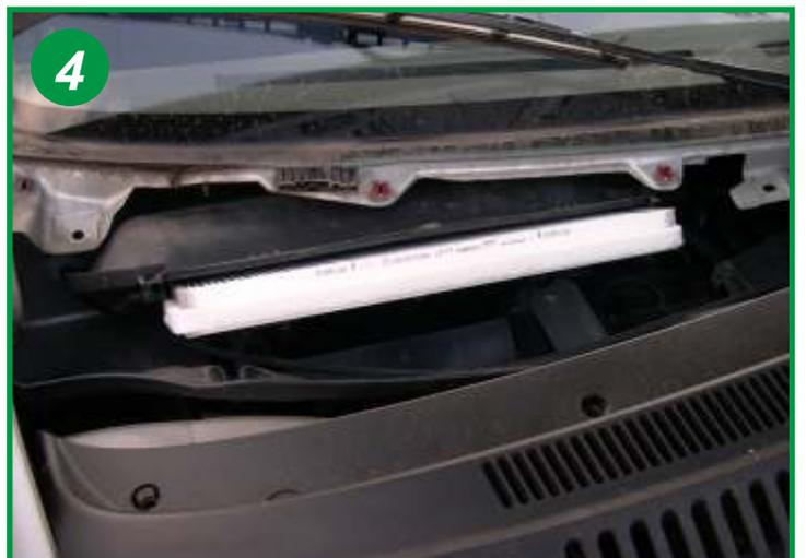
Replacer un nouvel élément dans son logement. Veiller à ce que le joint en mousse soit placé vers le bas. Le remontage s'effectue dans l'ordre inverse du démontage.
