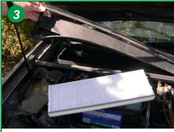
Extraire l'élément filtrant usagé et le remplacer par un nouvel élément.
