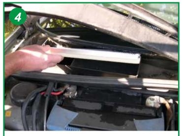
Replacer le nouvel élément filtrant en le positionnant dans le fond du boitier et l'encliqueter à l'aide des 4 ergots placés aux 2 extrémités de l'élément. Le remontage s'effectue dans l'ordre inverse du démontage.
