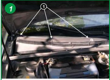
L'élément filtrant est situé sous le capot moteur sous la baie du pare brise coté passager.
