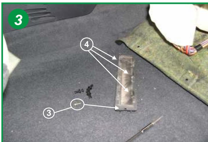
Dévisser le couvercle du boîtier de l'élément filtrant fixé par une vis six pans (voir flèche 3) et faire coulisser le couvercle d'environ 20 mm vers la gauche afin de désolidariser les ergots (voir flèche 4).
